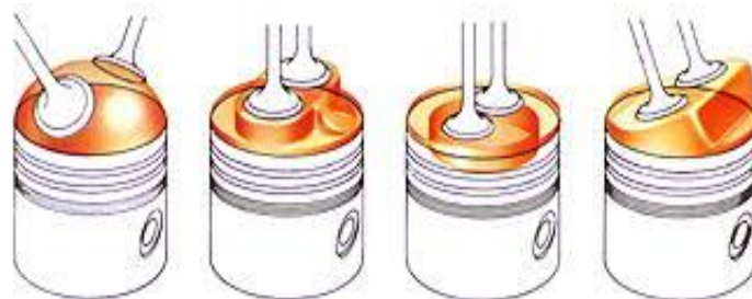
Razni oblici kompresijskih prostora u glavi motora
