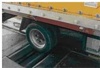
Da li svi kotači mog vozila dobro koče? To ne zna nitko dok se kotači ne postave u valjke i izmjeri sila kočenja i izračuna kočni koeficijent. Još važnije od sila kočenja je utvrđivanje da li na istoj osovini kočnice koče podjednako. Ako ne koče to znači da nas vozilo pri svakodnevnom kočenju u prometu zanosi u jednu stranu. U kritičnim trenucima kada kočimo naglo i velikim silama to može biti pogibeljno.
