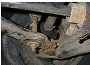
Ovo vozilo je imalo potpuno slomljeno prednje oscilirajuće rame. Ovakvi lomovi se događaju uslijed zamora materijala (dotrajalosti), ali i uslijed snažnijeg udarca kotačem u prepreku. Pitamo se kako je vozač mogao držati smjer i zar nije osjetio da mu vozilo bježi s ceste.
