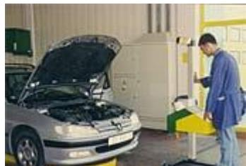
*Na tehničkom pregledu provjerava se usmjerenošć glavnih svjetala na vozilu. To se obavlja pomoći posebnog instrumenta - regloskopa. Ova provjera nam omogućuje da u prometu sudjeluju samo ona vozila koja nas ne zasljepljuju svojim svjetlima dolazeći nam u susret.*
