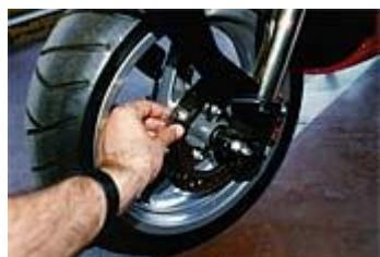
Vizualni pregled je vrlo bitan. Nadzornik s iskustvom može na osnovu debljine, izbrazdanosti i vanjskog ruba diska utvrditi da li su kočni elementi ovog vozila potrošeni.
