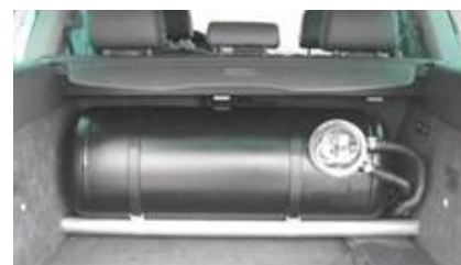
Primjer izvedbe cilindričnog spremnika za ukapljeni naftni plin
