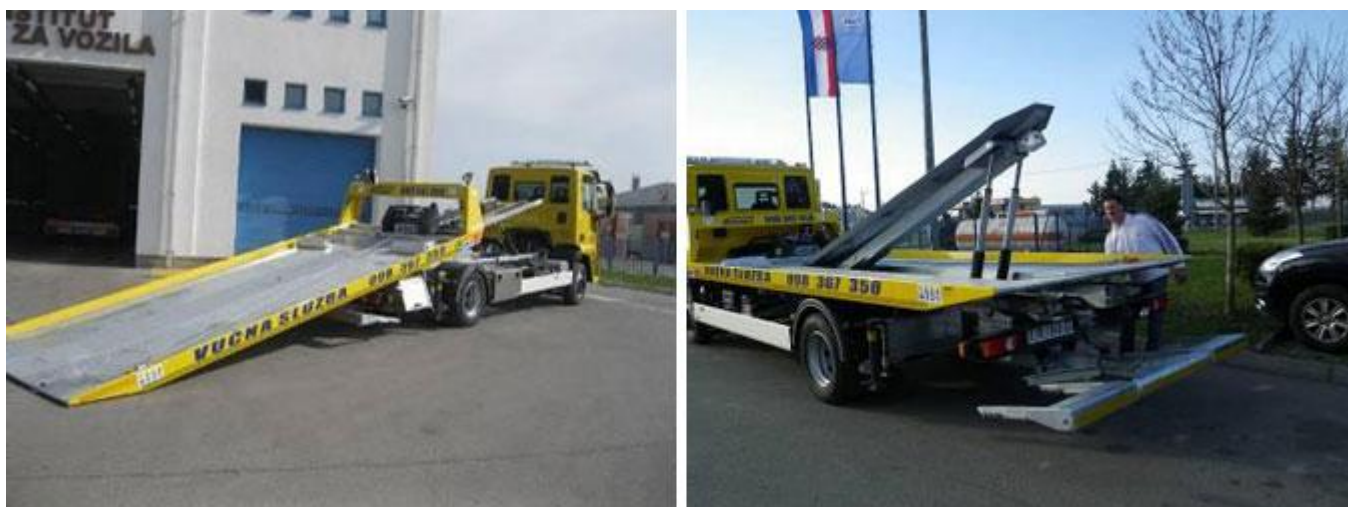
Izvedba klizne platforme za prijevoz automobila
