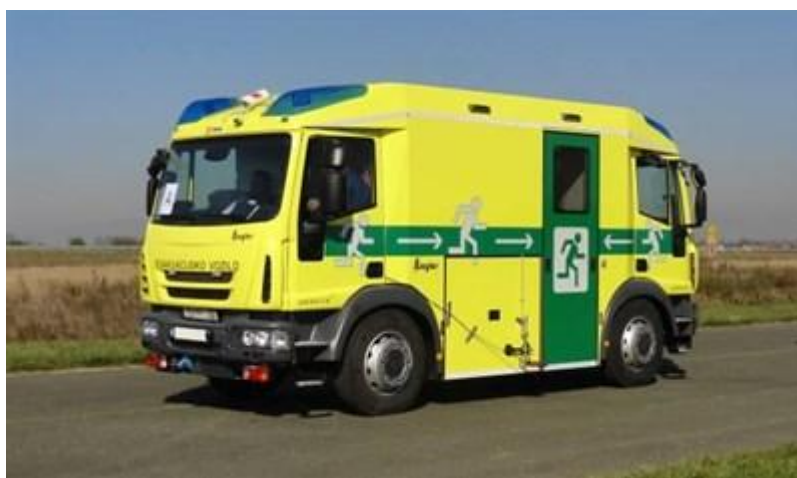
Specijalno elektrovozilo za spašavanje ljudi iz tunela
