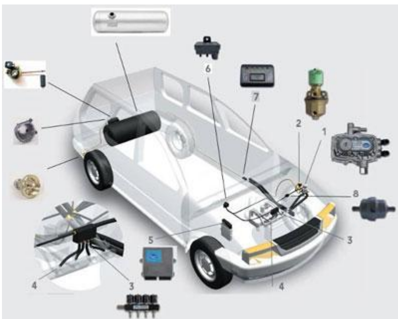
Primjer izvedbe plinske instalacije za UNP
