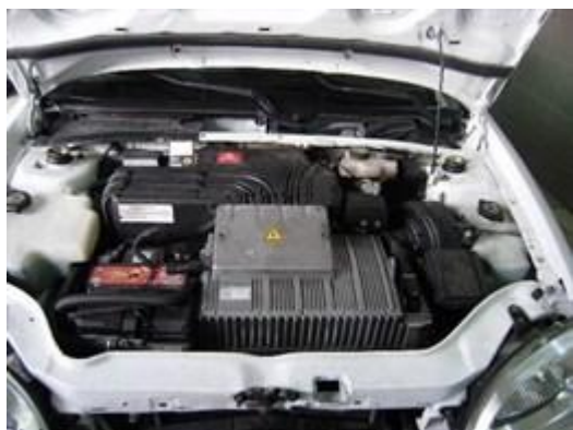
Izvedba vozila s elektromotorom kao pogonskim agregatom
