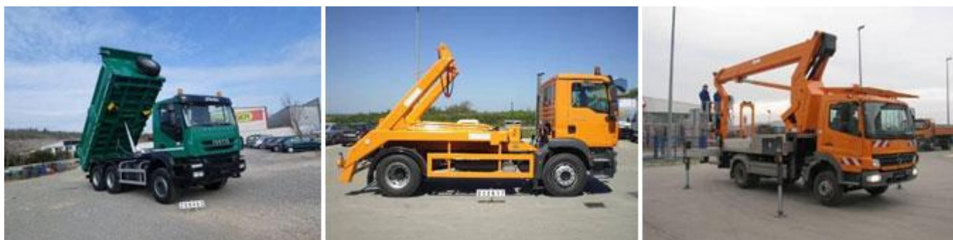
Izvedba samoistovarivača, vozila za prijevoz kontejnera i vozila s dizalicom i košarom za radnike
