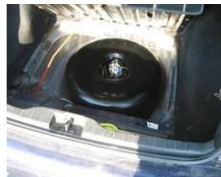
Primjer izvedbe torusnog spremnika za ukapljeni naftni plin
