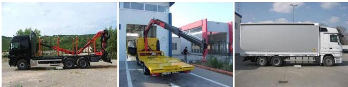
Izvedba vozila za prijevoz trupaca, platforme s dizalicom za prijevoz vozila i sanduka s ceradom
