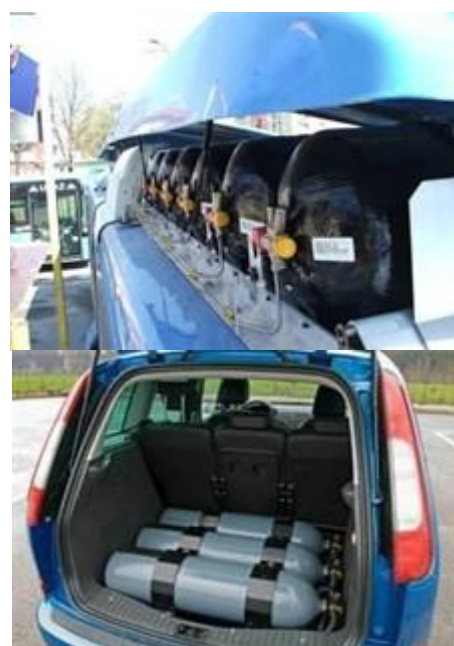
Primjer ugradnje metanskih spremnika na krovu vozila i prostoru za prtljagu
